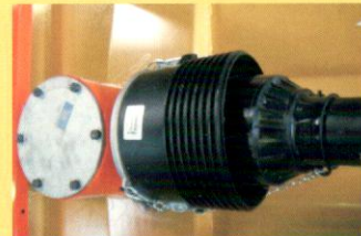
Embrague de fricción para evitar que los golpes y las paradas bruscas afecten a la transmisión del tractor. El embrague será de 2200 N/m para los grupos de 100 Cv. y de 1200 N/m en los de 70 Cv.
