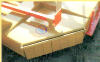
Cortina trasera fabricada en acero de 10 mm. para frenar la velocidad de posibles proyectados.
