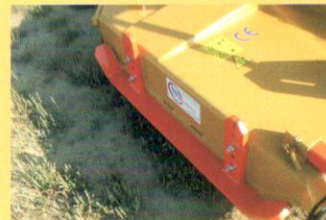
Patines regulables en altura que permiten varios niveles de altura.
