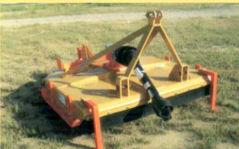
Cortina delantera en goma que parará todas las posibles proyecciones hacia adelante.
