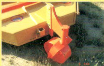
Rueda trasera giratoria 360 ° con regulación en altura para asegurar la uniformidad en el trabajo.
